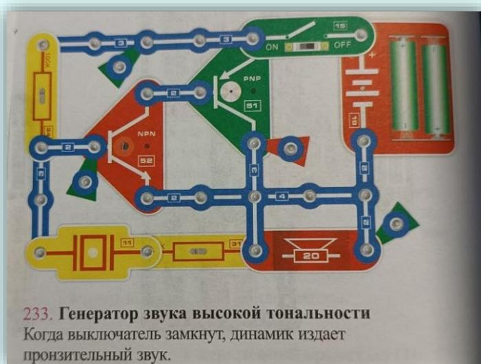
Рис. 10,11. Выбор сделан. Звонок конструируем по готовой схеме «Генератор звука высокой тональности»
